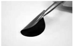
来自澳大利亚的研究人员开发出一种三维结构的新型石墨烯基薄膜,可吸收入射的90%以上阳光,同时消除大部分红外热辐射损失。该石墨烯基薄膜的设计,可吸收波长在0.28~2.5微米之间的光。铜基板结构使得它可作为选择性的带通滤波器,抑制内部产生黑体能量的正常发射,确保石墨烯基薄膜快速加热到83℃。
